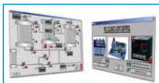
Das SCADA-Programm ist eine Standard-Branchenanwendung für die Überwachung, Steuerung und Datenerfassung zu Produktionsprozessen über den Computerbildschirm.
