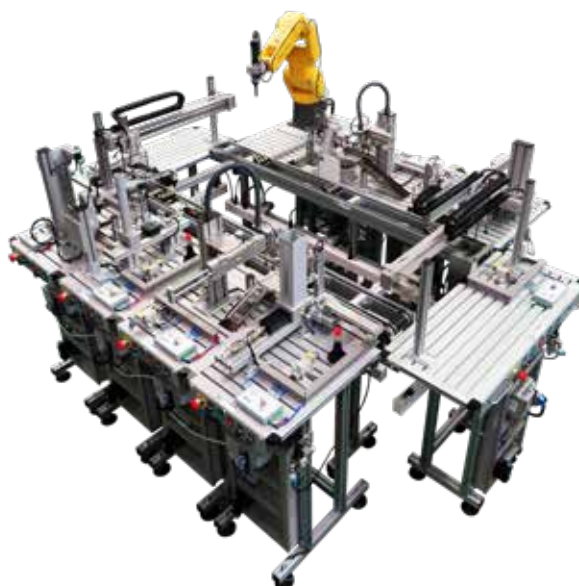
Configuración de 10 estaciones con transfer
