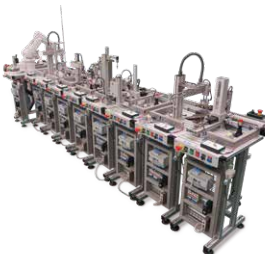
Configuración de 8 estaciones con transfer
